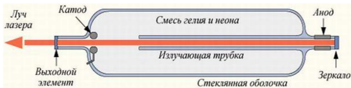
Рис. 3.4. Устройство гелий-неонового лазера
