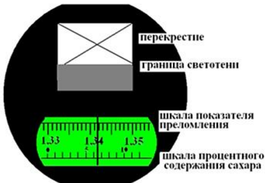
Рис. 2.9. Изображение в окуляре рефрактометра
